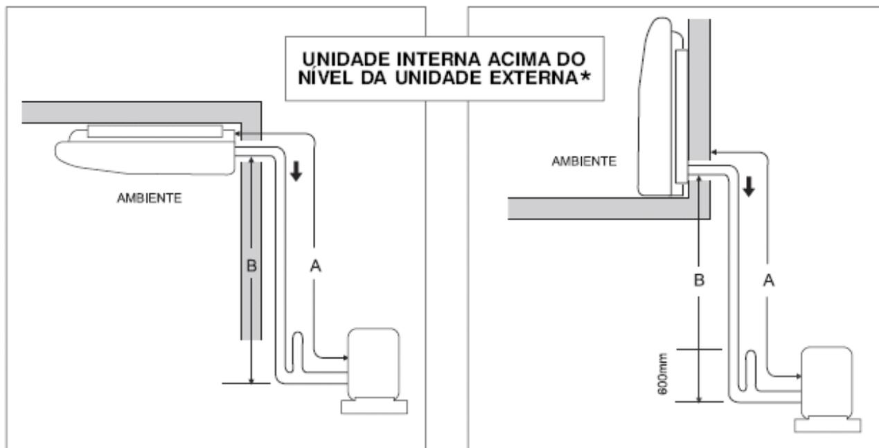
\* NESTA SITUAÇÃO, RECOMENDA-SE A INSTALAÇÃO DE UM SIFÃO NA LINHA DE SUÇÃO PARA PROTEÇÃO DO COMPRESSOR, AMENIZANDO EVENTUAIS GOLPES DE FLUIDO REFRIGERANTE EM FORMA LÍQUIDA.
